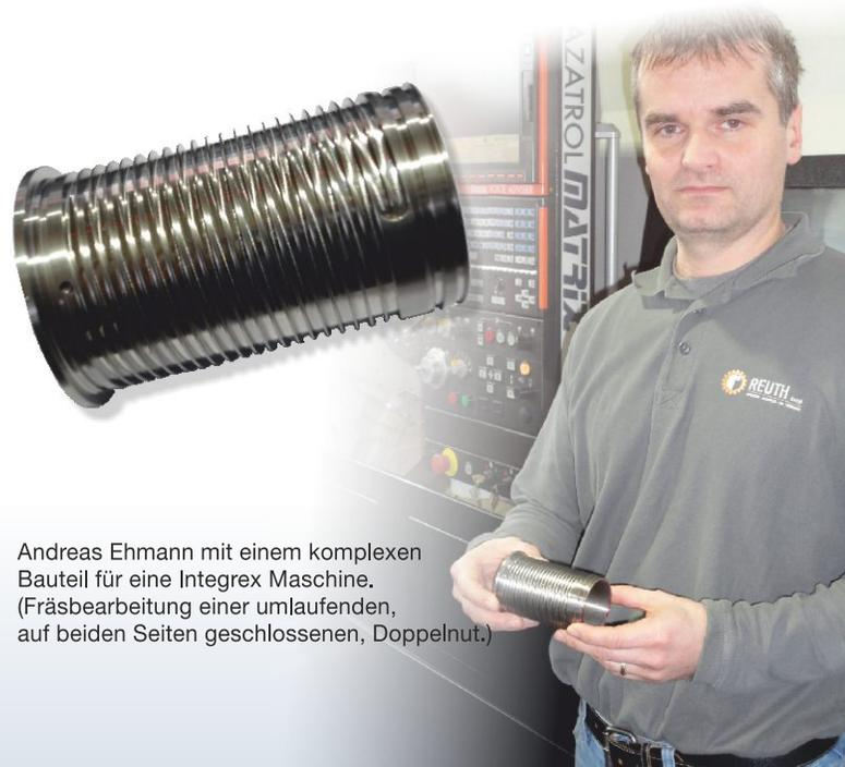
Andreas Ehmann mit einem komplexen Bauteil für eine Integrex Maschine. (Fräsbearbeitung einer umlaufenden, auf beiden Seiten geschlossenen, Doppelnut.)
